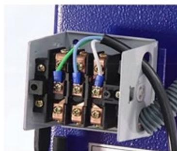
O esquema de ligação à rede elétrica, é o mesmo para os elevadores trifásico UP2800 e UP4300, lembrando que para o modelo de 4t, como possui dois motores, o chicote de energia que passa pela base, também deve ser conectado de acordo com as cores correspondente nas duas pontas.
